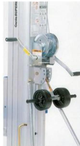
**Verricello a una velocità:** verricello azionato a mano con due manopole comprende un dispositivo silenziatore e frizione automatica (in qualunque posizione lo si lasci, il verricello non si muove).
