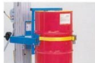
**Accessorio girevole sollevamento fusti:** permette il sollevamento, ribaltamento, riempimento o svuotamento di fusti di metallo da 113 e da 208 l muniti di anello di rinforzo. Rotazione continua di 360°. Solleva i fusti da terra sia in posizione verticale che orizzontale. Disponibile sui modelli SLA-10 e SLA-15.
