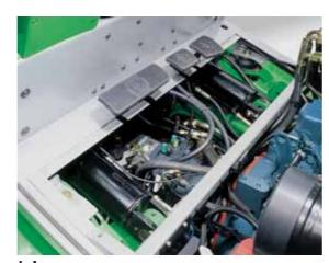
L'alloggiamento dell'idroguida sotto la pedana consente una semplificazione dei collegamenti ed una minore rumorosità di marcia. Le pedaliere sono montate sulla plancia per consentire una più immediata manutenzione.
