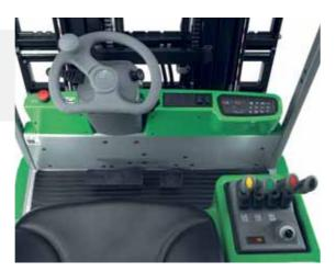
Comandi ergonomici. Il freno di stazionamento comandato da un selettore girevole è sempre a portata dell'operatore. Il piantone dello sterzo è inclinato verso l'operatore ed è facilmente regolabile per aumentare il confort durante la guida.
